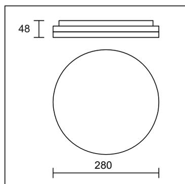
Armature et diffuseur en matière synthétique blanc. Prêt pour monter avec convertisseur intégré. CRI>80.
